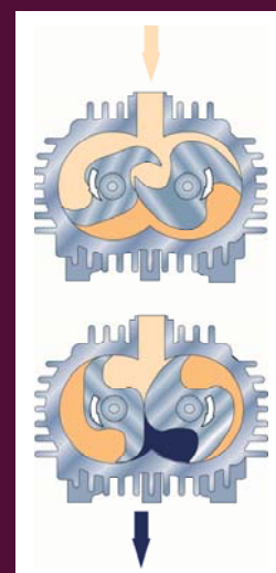
Kompressionsprincippet i en Mink Klo vakuumpumpe
